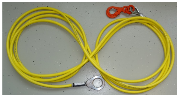
Qui: Corda arrotolata a forma di otto per poterla stoccare senza comprimerla.
