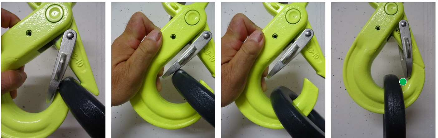
Haken öffnen und den schwarzen Beschlag einführen (im Bild AM_KAU_MIL). Haken öffnen lassen und den schwarzen Beschlag vollständig einführen. Der Beschlag sitzt korrekt, wenn die 2. Sicherungsfalle geschlossen ist
