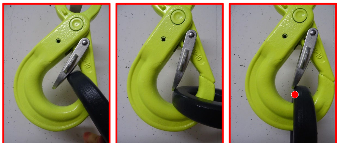
Missbrauch! Wenn der Haken nach dem Einführen des schwarzen Beschlages sofort geschlossen wird, kann die 2. Sicherungsfalle nicht schliessen.
