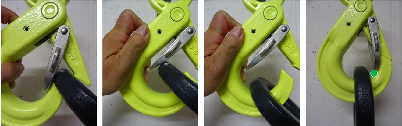
Fig. 18 – 21: Aprite il gancio e portate l'accessorio/la redanca sul suo becco. Fate scivolare l'accessorio fino in fondo tenendo il gancio aperto. L'accessorio sarà correttamente posizionato solo quando la 2a linguetta di sicurezza è completamente chiusa.
