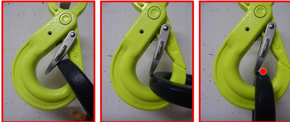
Fig. 22 – 24: Uso inappropriato! Se si chiude il gancio subito dopo aver inserito l'accessorio nero, la 2a linguetta di sicurezza non si potrà chiudere correttamente.
