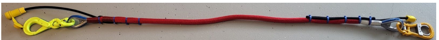
Fig. 4 : AM_NH90_SKG avec maillon de jonction Connex SKT-13-8 monté directement sur la cosse. Ici, sur une corde utilisée dans l'extinction d'incendies TLME_25_2_BW.
