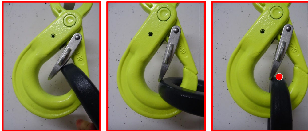
Fig. 22 – 24 : Utilisation inappropriée ! Si l'ouverture du crochet est fermée immédiatement après avoir inséré l'accessoire noir, le linguet de sécurité ne peut pas être correctement verrouillé.
