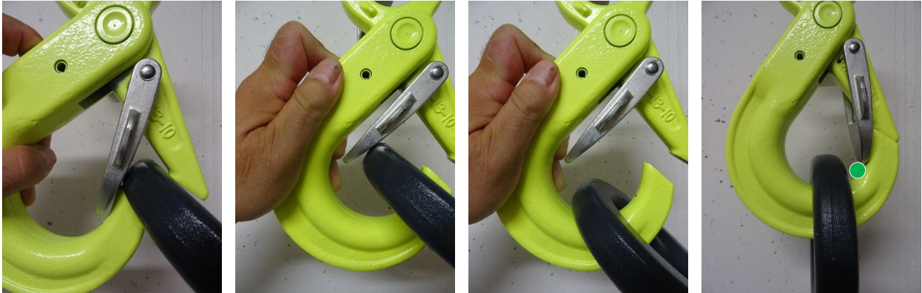
Fig. 18 – 21 : Ouvrir le crochet et positionner l'accessoire/la cosse sur le bec du crochet. Maintenez le crochet ouvert et insérez l'accessoire jusqu'au fond du crochet. L'accessoire n'est correctement placé que lorsque le 2 e linguet de sécurité est complètement fermé.
