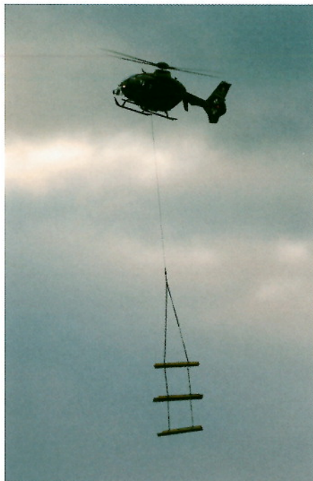
Unterschiedliche Anschlagetechniken: Links sind die Doka-Balken seriell am EC635 eingehängt, rechts parallel. Deutlich ist das unterschiedliche «Flugverhalten» zu sehen.
