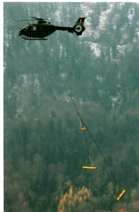
Unterschiedliche Anschlagetechniken: Links sind die Doka-Balken seriell am EC635 eingehängt, rechts parallel. Deutlich ist das unterschiedliche «Flugverhalten» zu sehen.
