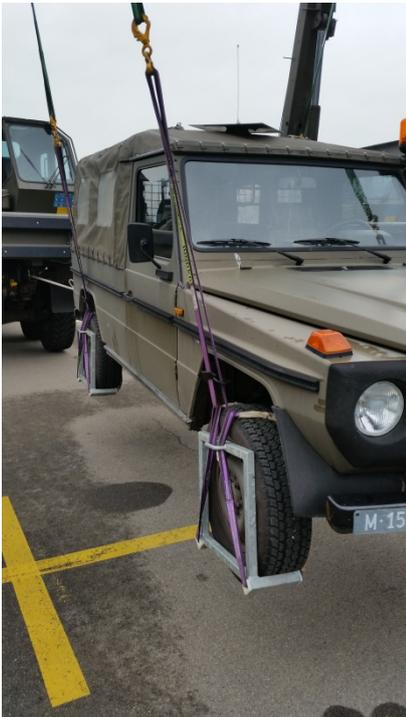
Puch de l'Armée Suisse avec dispositif pour le soulèvement de véhicules
