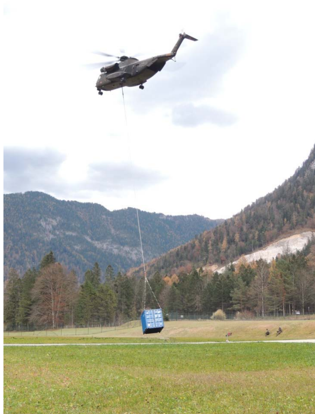
Fig. 1: CH-53 des forces aériennes, équipé de corde TLM_90_30 (WLL 90 kN). Crédit photo : Airbus MSC.
