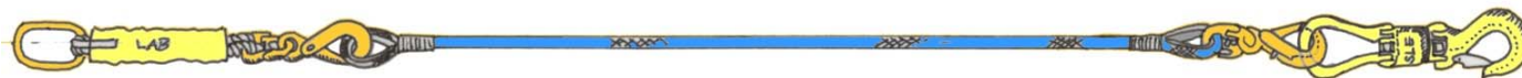
Fig. 10: Configuration de base des cordes manuelles ou hybrides avec amortisseur (VM-DP), Short ou LongLines (p. ex. TLDS+, TLM), élément de lest stabilisateur avec compensateur de torsion intégré (SLE1).
