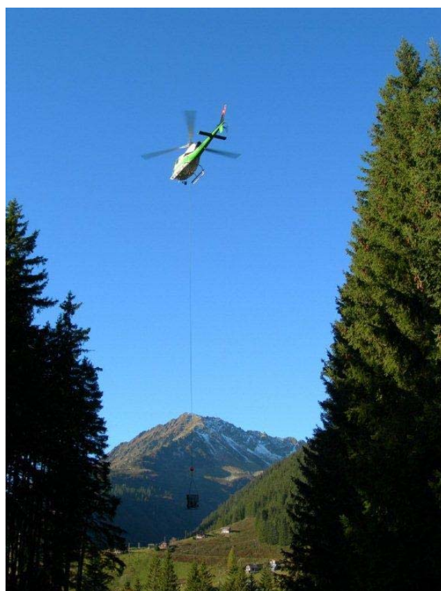
Fig. 2: AS350B3 de la Swiss Helicopter AG (Heli Gotthard) avec TLDS_14 (WLL 14 kN)
