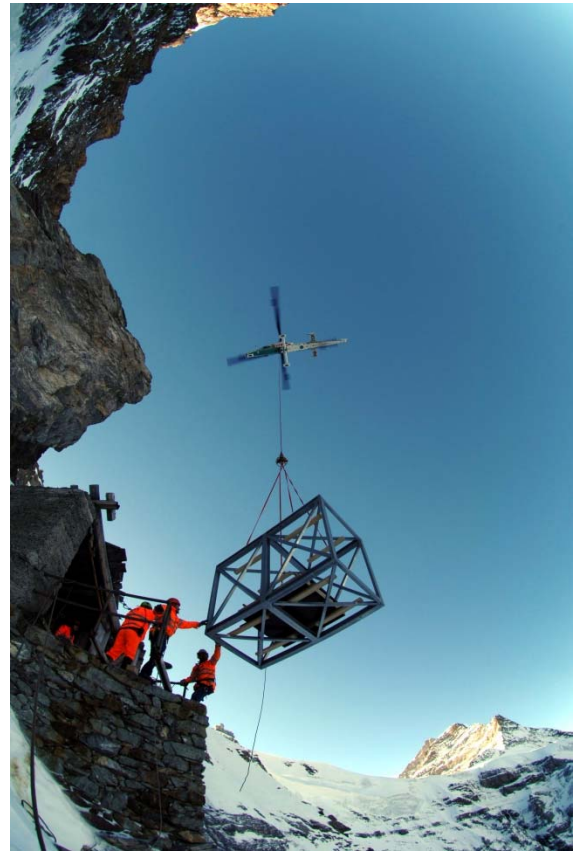
Abb. 4: KAMAN K-1200 "K-MAX" mit TLP_55_30 (WLL 30 kN). MFG SBV
