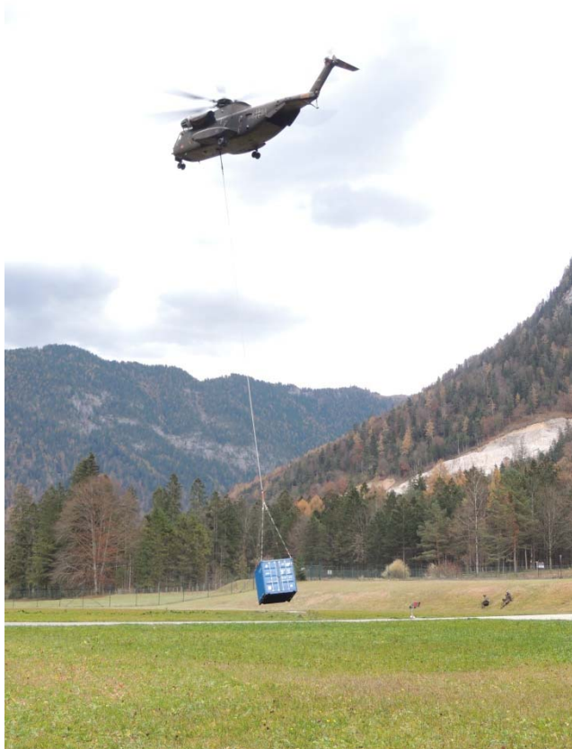
Abb. 1: CH-53 der Heeresflieger mit Leine TLM_90_30 (WLL 90 kN). MFG Airbus MSC
