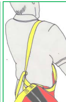
Fig. 4: Far passare sopra le spalle
