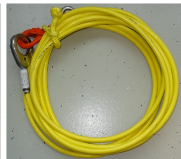
wenn gewünscht mit einem Band, Schäkel oder – wie hier – mit einem Textilschäkel zusammen halten
