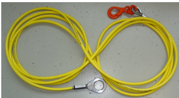
Seil auf- und abschleifen von Hand siehe AWA Teil 1. Hier: Seil beim Wickeln zu einer Acht gelegt. Dies erlaubt eine zwangsfreie Ablage.
