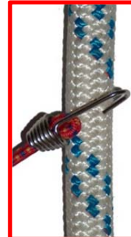
Fissaggio della corda abbiacciata con una delle sue estremità
