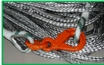
Fixierung des aufgeschossenen Seils mit einem Seilende
