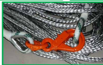
Fixierung des aufgeschossenen Seils mit einem Seilende
