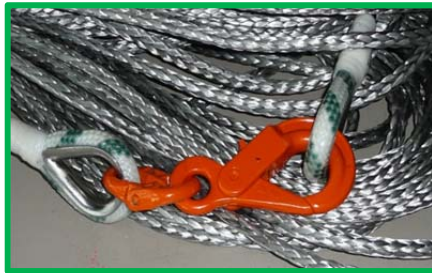
Fixierung des aufgeschossenen Seils mit einem Seilende
